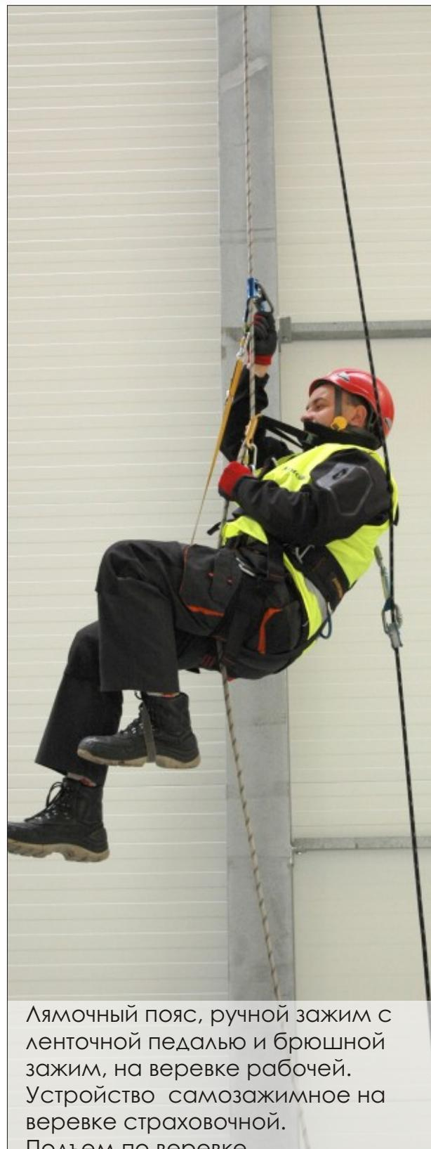
Лямочный пояс, ручной зажим с ленточной педалью и брюшной зажим, на веревке рабочей. Устройство самозажимное на веревке страховочной. Подъем по веревке.
