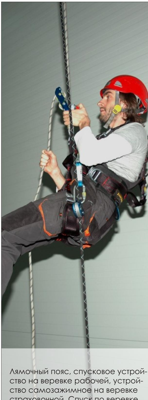
Лямочный пояс, спусковое устройство на веревке рабочей, устройство самозажимное на веревке страховочной. Спуск по веревке
